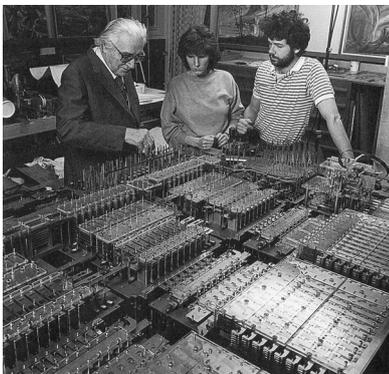
Konrad Zuse (1910-1995) hat bereits 1937 einen mit mechanischen Schaltgliedern nach binärem Prinzip arbeitenden programmgesteuerten Rechner mit Gleitkomma-Zahlendarstellung fertiggestellt.
